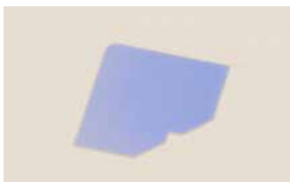
Napromienij pasek pomiarowy światłem UV; pasek pomiarowy zmieni kolor na ciemnoniebieski
