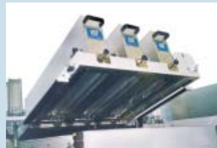
Inertisierte UV-Anlage für die Silikonisierung Inerted UV unit for siliconisation
