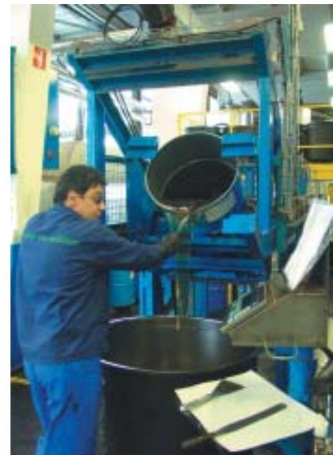
Bild 3: Die Farbqualität ist auch vom exakten Abwiegen der einzelnen Farbbestandteile abhängig.
