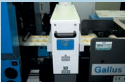
Eines von 28 IST UV-Aggregaten in den Gallus Druckmaschinen. One of the 28 IST UV dryer set up on the Gallus line.
