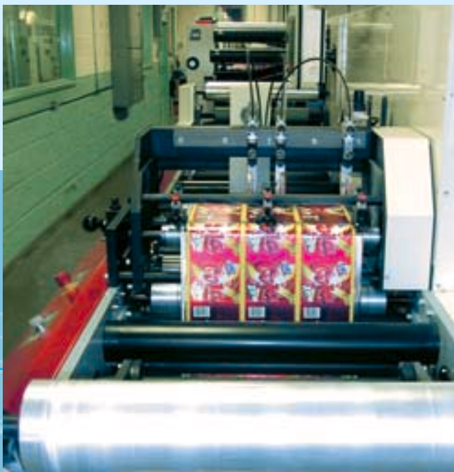
MPS EP510 Druckmaschine 1 bei Townsend, Druck auf 40 µm PET. MPS EP510 press 1 at Townsend, printing on 40 micron PET.
