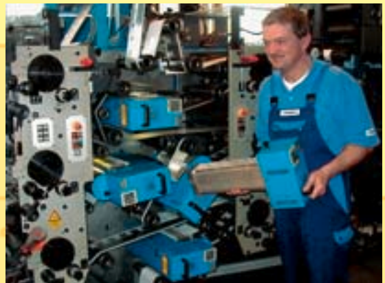
Ein modular austauschbares UV-Aggregat war eine von PAGO bereits im ersten Pflichtenheft festgehaltene Forderung. One of PAGO's requirements in the very first system specification was a modular interchangeable UV system. Foto / Photo: Ehrlitzer
