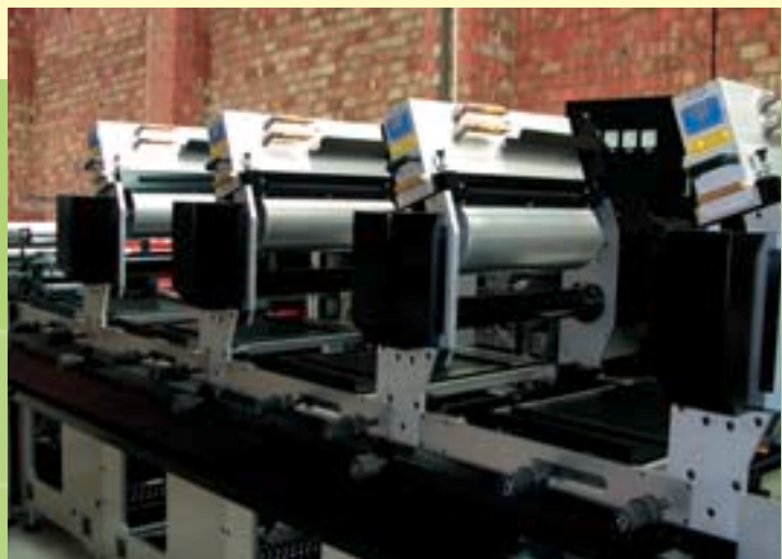
Edale Sigma 510, 4-Farben Druckmaschine mit IST BLK® Strahleraggaten. Edale Sigma 510, 4-colour printing press with IST BLK® lamp modules.
