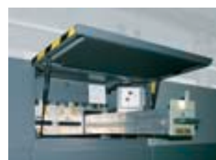
Sécheurs UV IST à la fin Moduli finali IST UV
