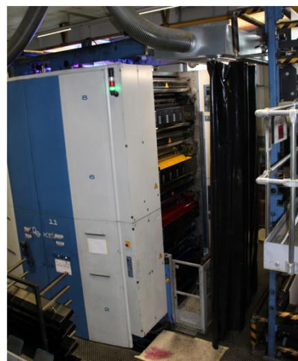
**Einer der beiden Türme der KBA Commander CT mit dem aufgesetzten Härtings-Strahler, der Absaugung und Vorhängen.**
