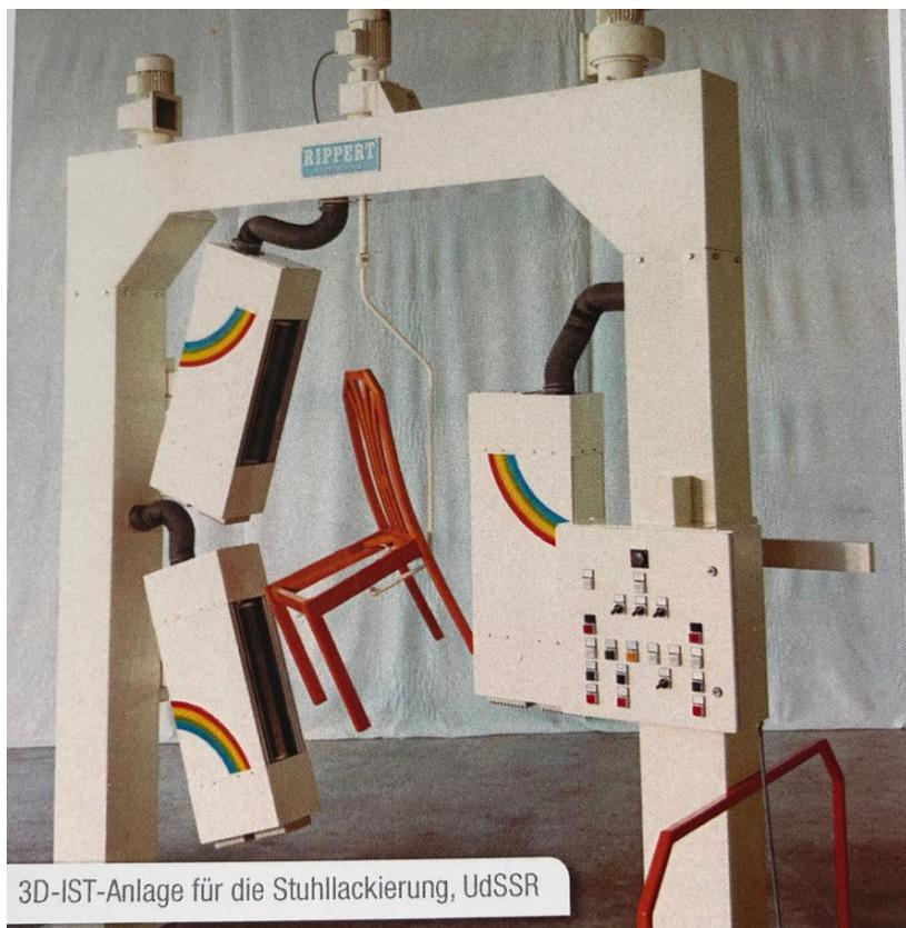
3D-IST-Anlage für die Stuhllackierung, UdSSR
