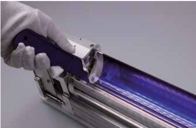
Die UV-Lampe wird von den Kontakten abgezogen und aus dem Aggregat herausgenommen.
