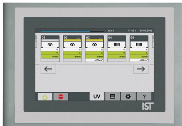
Das Hauptmenü des Smart Control Touchpanels
