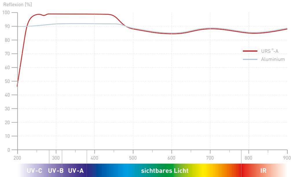
Der URS® A Reflektor verfügt im UV-Bereich über einen deutlich höheren Reflektionsgrad als konventionelle Aluminium-Reflektoren. Im Bereich der IR-Strahlung (Wärmeabstrahlung) sind die Reflektionseigenschaften der beiden Reflektortypen nahezu identisch.
